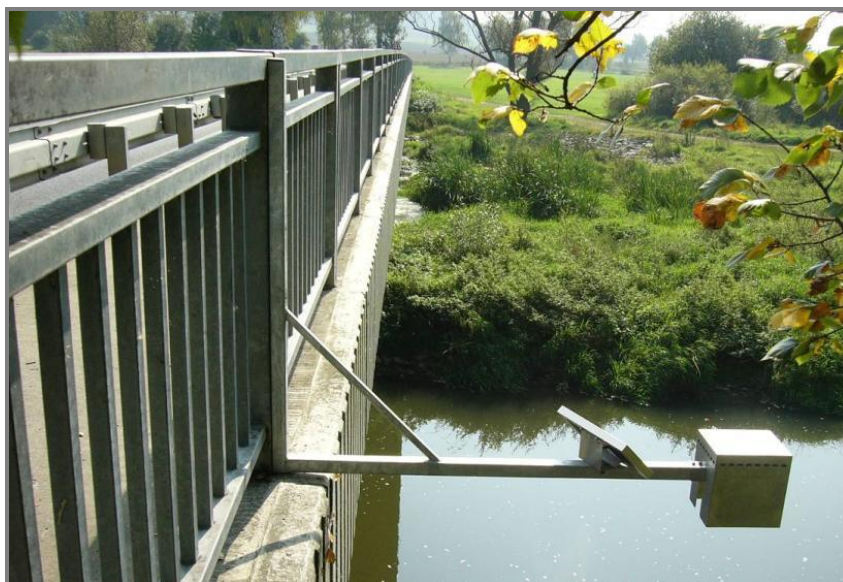
Obr. č. 6.: Ilustrativní příklad umístění ultrazvukového čidla pro měření vodní hladiny
